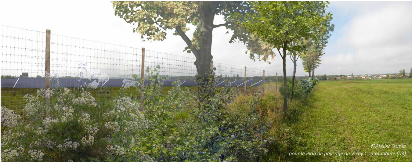
Ci-contre, simulation d’une clôture en piquets de châtaigniers et grillage (type ursus lourd), située à l’arrière de plantations d’essences locales, implantées de façon discontinue (non répétitive et non homogène), à 3 strates (arborée, arbustive, enherbée). Les plantations sont dans le périmètre de la parcelle à clôturer. Hauteur de clôture de 2m.
