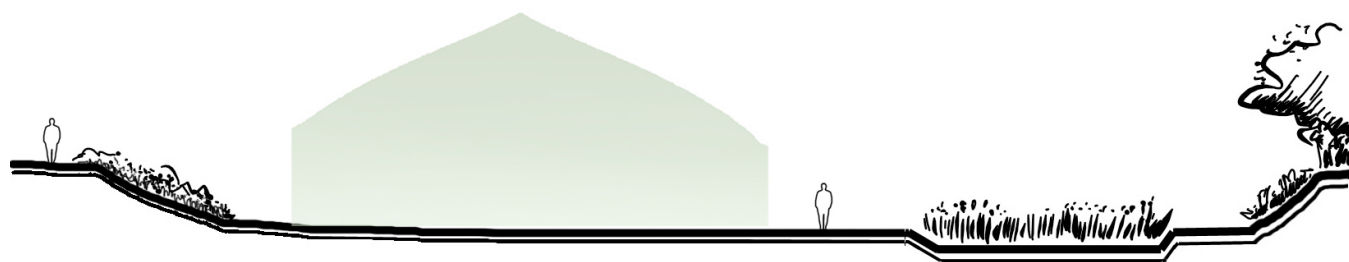
Coupe montrant l'intégration d'une cuve dans le relief (rendue discrète en contrebas d'un talus) et la réalisation d'un bassin de gestion des eaux pluviales planté.
